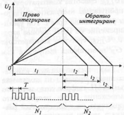
Фиг. 7.29. Времени диаграми на процеса на преобразуване при двукратно интегриращ преобразителен АЦП.
