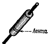
Фиг. 5.4. Лентата на цилиндричния кондензатор показва края, който е свързан към външното фолио. Този край трябва да бъде свързан към земя
